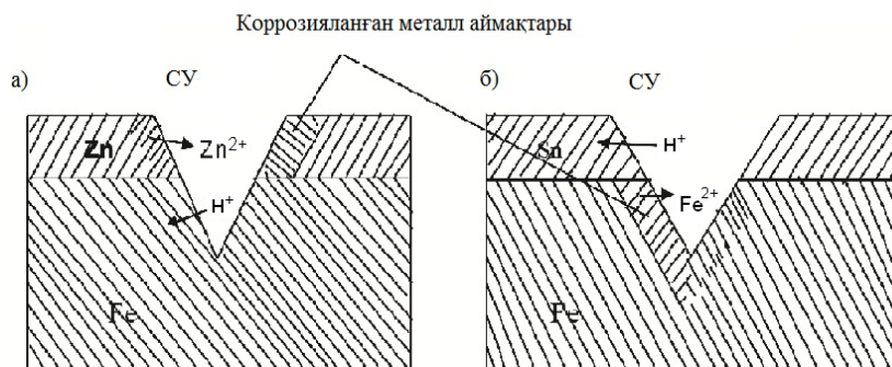
1-сурет. Темір бұйымға мырыш (а) және қалайы (б) қаптамасын қондырғаннан кейінгі коррозиялану сызбанұсқасы
